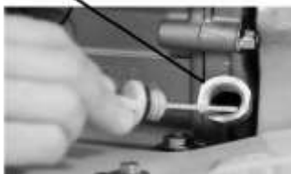
Sl. 5a – Proveravanje nivoa ulja u motoru
